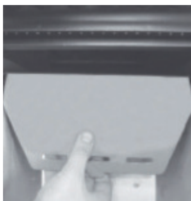
Fig. 16: tourner la plaque coupe-flamme
