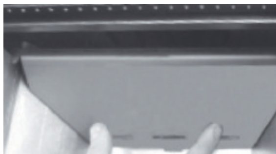
Fig. 14: soulever la plaque coupe-flamme
